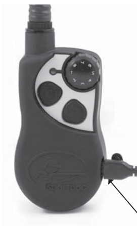
LADER STRØMSLUTTER ANBRAGT I FJERNSENDERENS OPLADNINGJACK
