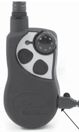
CONNECTEUR DU CHARGEUR DANS LA PRISE DE CHARGE DE L'ÉMETTEUR À DISTANCE
