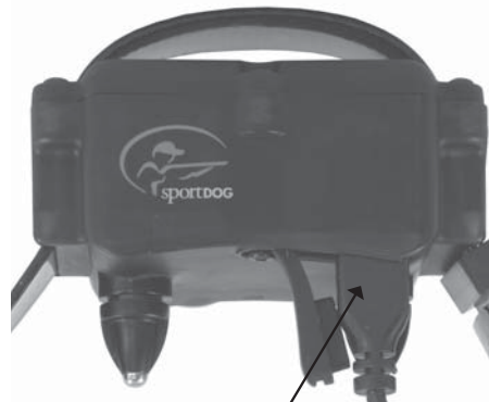
EL CONECTOR DEL CARGADOR COLOCADO EN LA TOMA DE CARGA DEL COLLAR RECEPTOR
