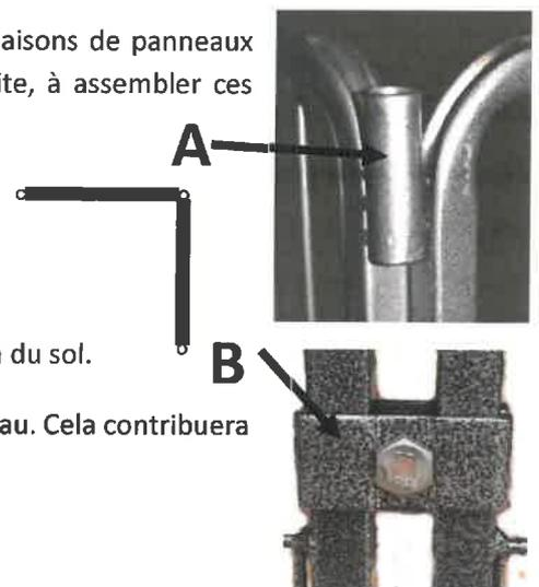
Une fois le premier angle assemblé, positionnez à suivre et dans le prolongement d'un des deux panneaux déjà installés un nouveau panneau. Avec un maximum de 3 panneaux sur la largeur et de 3 panneaux sur la longueur, si vous avez opté pour l'option toit. Sans quoi vous êtes libre de donner au chenil la forme qui vous convient.
