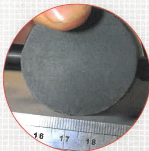
Mesurer le diamètre de la barre supérieure puis inférieure à 90 degrés de différence comme indiqué sur les photos ci-dessous. Si la différence entre ces 2 mesures est supérieure à 1mm alors la barre est usée et le descendeur de Fast Rope doit être retiré de son service
