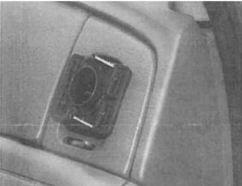
Enfilez une extrémité du tuyau dans la coupelle du tableau de bord
