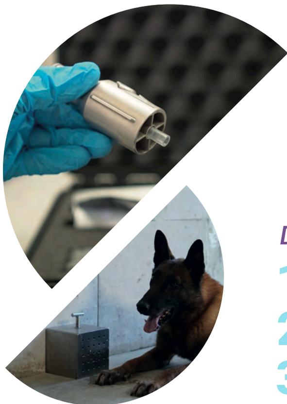
Notre système d'échantillonnage d'air à distance est une solution unique et abordable pour collecter et concentrer les substances volatiles contenues dans de grands volumes. Le système Getxent RASCO est basé sur la combinaison du tube Getxent et d'un accessoire spécialement conçu pour s'adapter à un aspirateur Dyson.
