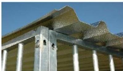
Un lot de 7 Vis auto-foreuses et rondelles étanches de fixation toiture sont incluses par tôle de toiture (recommandation de pose : 4 vis par tôle face avant, 3 vis par tôle face arrière)
