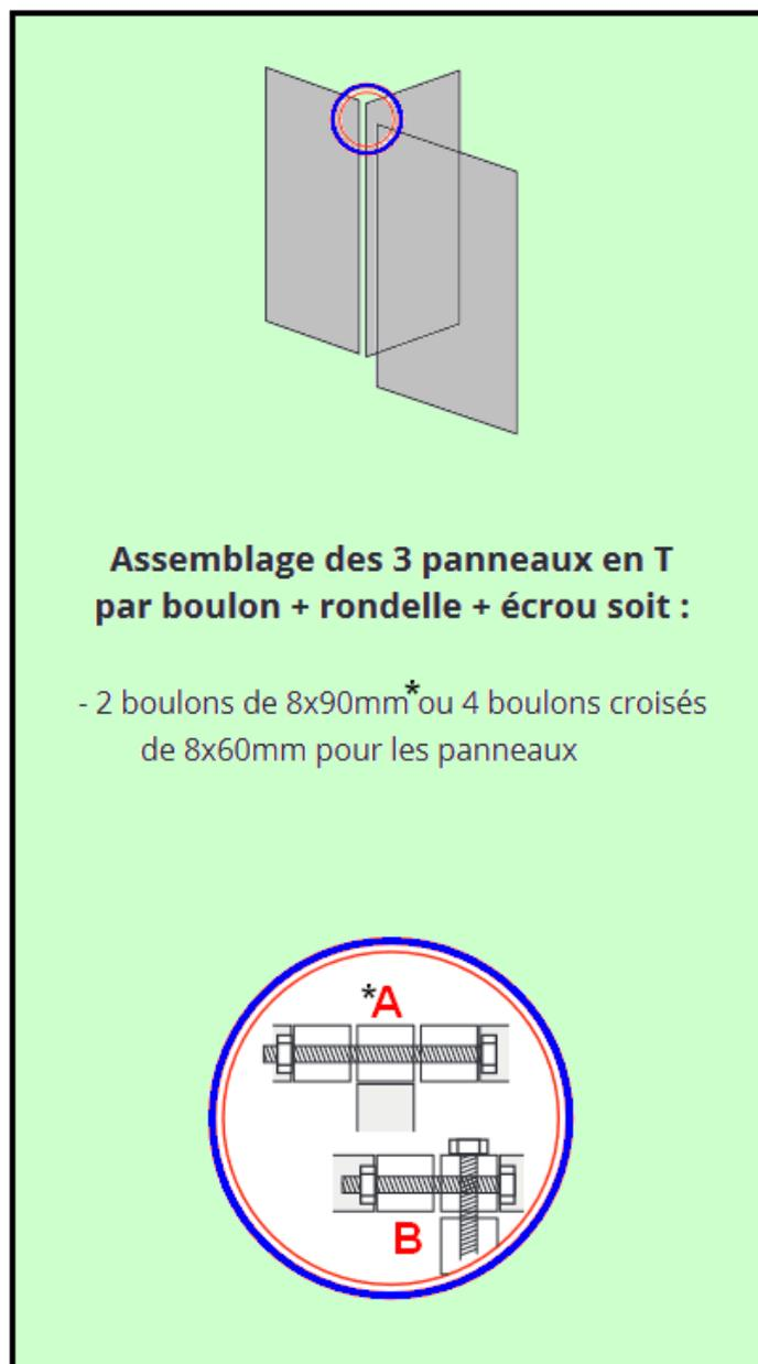
Pour le montage en T de type **B**, utiliser les vis M8x60 fournies avec les panneaux
