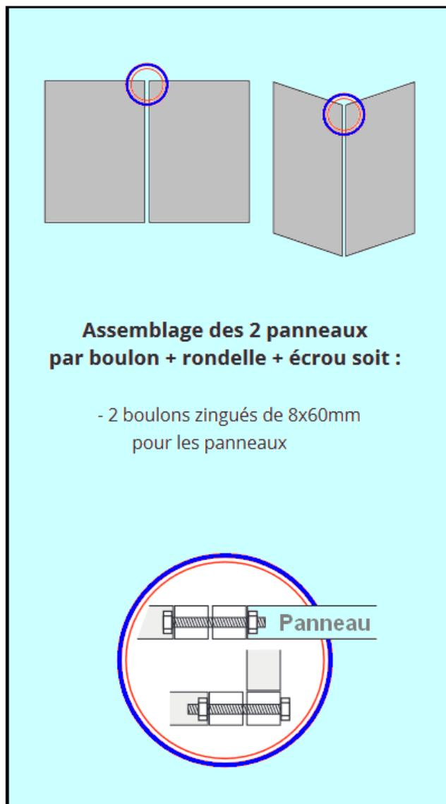
Illustration pour montage T de type **B** en utilisant 2 panneaux pour 1 longueur et 1 panneau de séparation.
