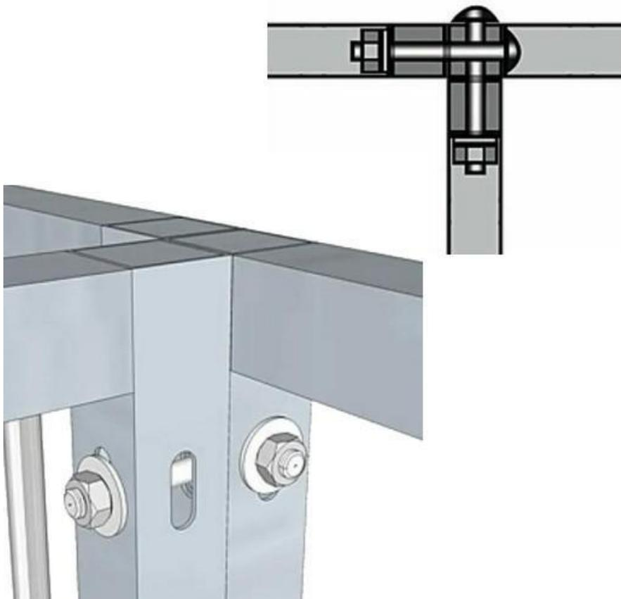
Illustration pour montage aligné ou en angle 2 panneaux pour 1 longueur ou 1 angle.
